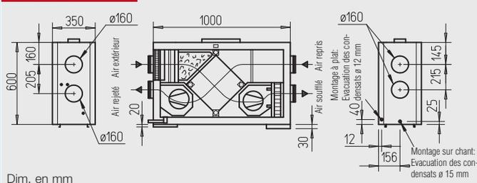
Centrale double flux de faible encombrement avec récupération de chaleur, pour montage en intérieur à plat ou sur chant.
