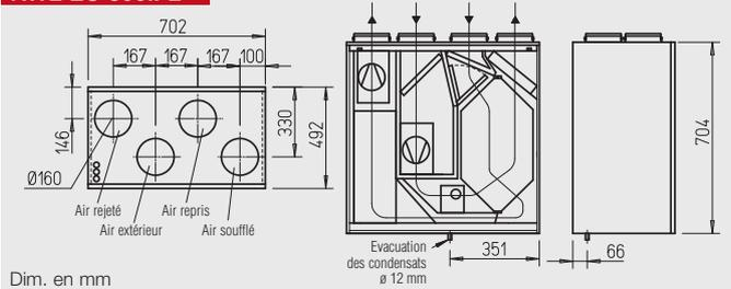
**Groupe d'extraction et d'introduction d'air centralisé avec récupération d'énergie pour appartements et maisons individuelles. Echangeur de chaleur à contre courant en aluminium, rendement jusqu'à > 90%. Moteurs basés sur la nouvelle technologie EC.**
