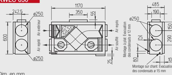
**Centrale double flux de faible encombrement avec récupération de chaleur pour montage en intérieur à plat ou sur chant.**
