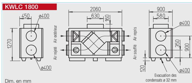
Centrale double flux de faible encombrement avec récupération de chaleur pour montage en locaux techniques.
