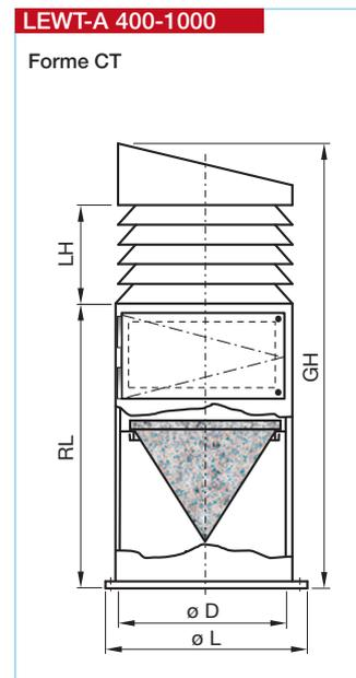
La borne de prise d'air extérieur est un élément indissociable du puits canadien (ou provençal). Elle doit être esthétique, solide, résister aux intempéries et éviter l'introduction de corps étrangers dans l'échangeur géothermique.
