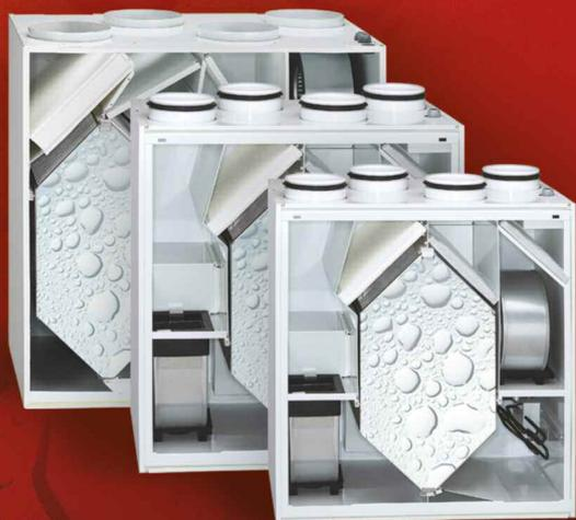
Centrales double flux avec échangeur enthalpique de série pour la récupération de la chaleur et de l'humidité. Rendement jusqu'à 116 %, testé par le TÜV selon les critères établis par le DIBT (Centre technique du bâtiment allemand).
