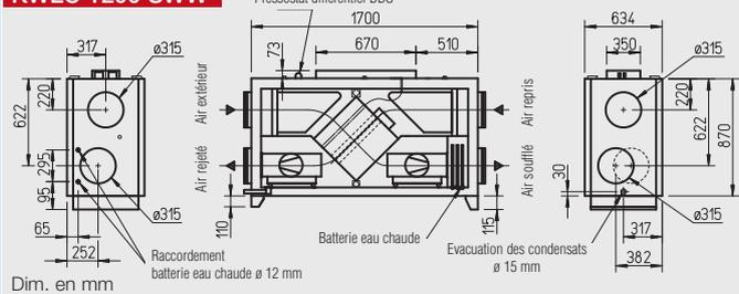
Centrale double flux de faible encombrement avec récupération de chaleur pour montage en locaux techniques.
